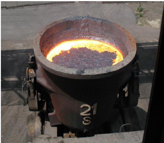
view inside slag ladle with hot BOF slag
