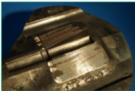
Worn forging die
